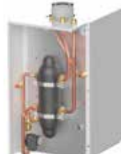
Kit botella de equilibrio Profundidad del kit 250 mm. Ida/retorno 1" 1/2. Conexión gas 1".
